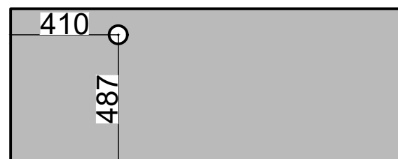
Markering locatie HWA of riool onder de Athena H/HC buitenunit
